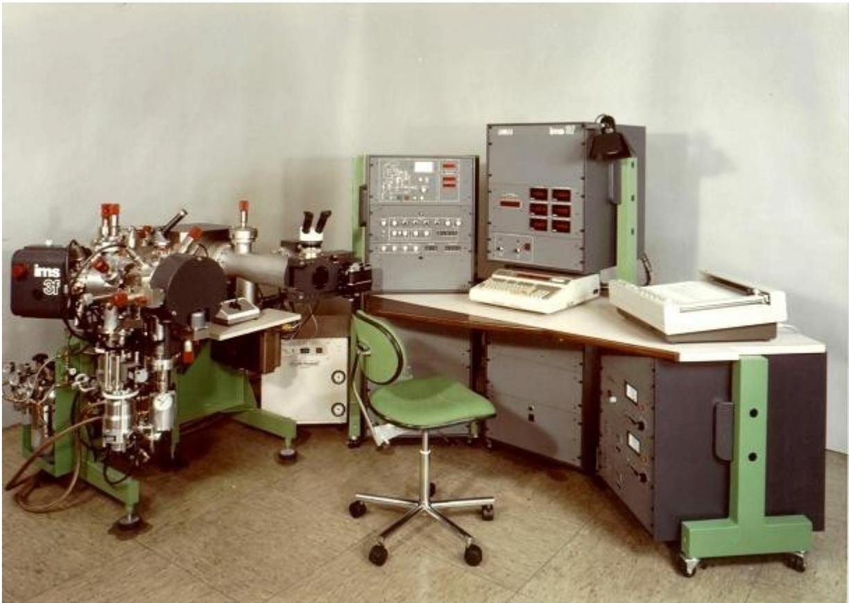
Tous les problèmes de mise au point furent réglés par Lepareur dont le plus gros souci fut la vulnérabilité de l'électronique basée sur la nouvelle technologie CMOS. Chaque flash produisait son hécatombe de circuits CMOS. L'instrument fut prêt au bon moment, la résolution en masse meilleure que 5000, et la concurrence d'ARL définitivement coulée.
