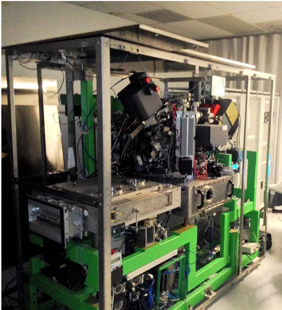
En plus de la faible énergie d'impact, il y avait des angles d'impact optimum différents pour le Cs ( $60^\circ$ ) et l'O<sub>2</sub> ( $<45^\circ$ ). Cela conduisit à implanter 2 colonnes primaires. En plus des deux colonnes primaires, une interférométrie laser était censée mesurer la profondeur en temps réel.
